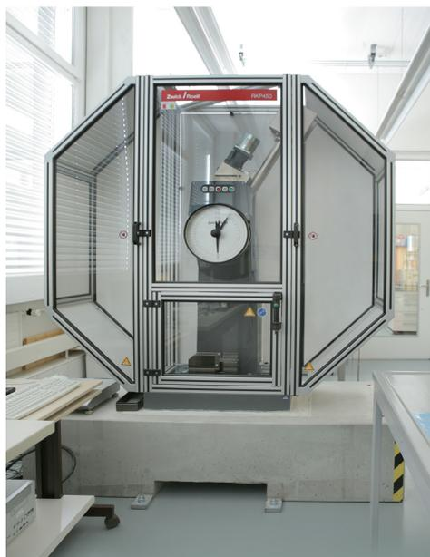
Bild 1: Pendelschlagwerk
