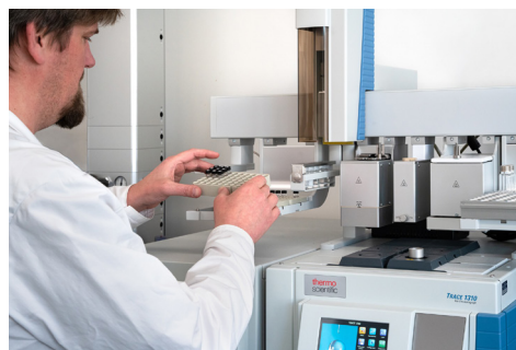
Abbildung 1: GC-MS/MS: eine Methode zur Identifikation und Bestimmung geringster Mengen organischer Spurenelemente.
