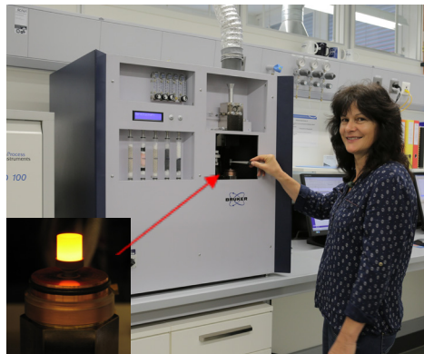
Bild 2: TGHE-Analysator (Bruker G8 Galileo) für die O, N, H und Ar-Analyse. Kleines Bild: glühender Graphitiegel bei ca. 2000 °C
