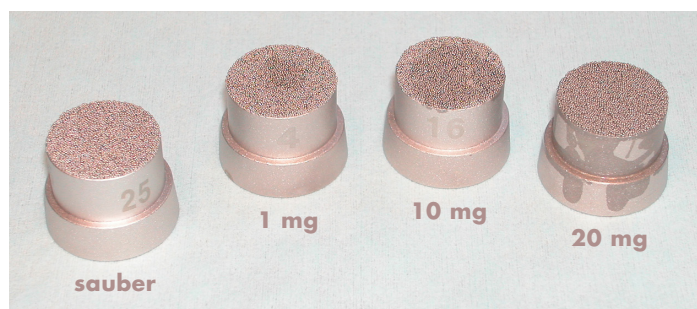
Angeschmutzte Testproben, die für die Validierung von Reinigungsanlagen verwendet werden.
