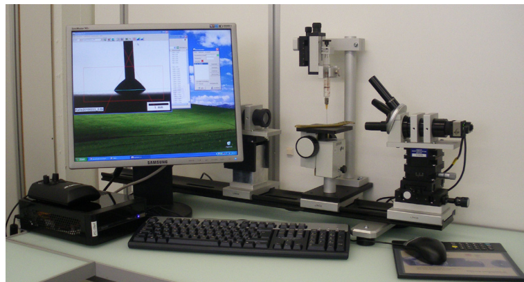
Abbildung 1: Kontaktwinkelmessgerät in der RMS Foundation.
