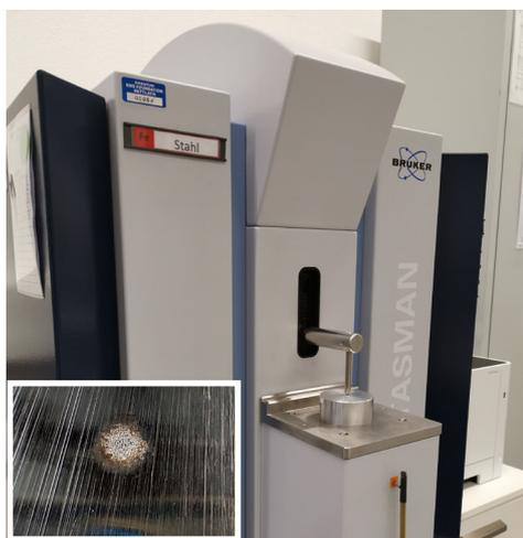
Abbildung 1: Funken-Emissionsspektrometer (OES Messmethode) und Ø 5 mm Brandfleck auf der Stahlprobe.
