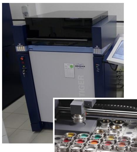
Abbildung 3: WD-XRF Messgerät.
