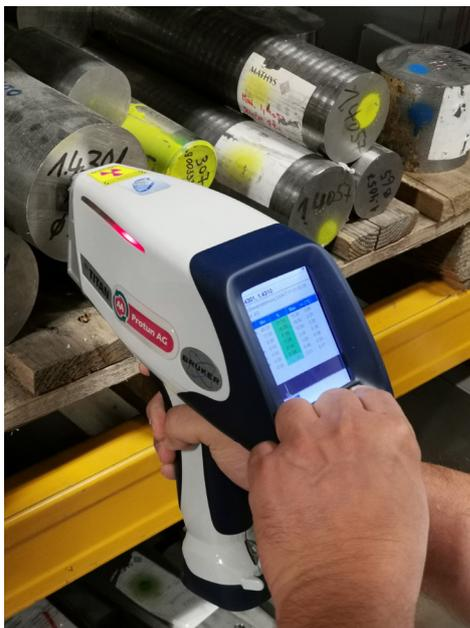
Abbildung 2: Mobiles Röntgenspektrometer im Einsatz.
