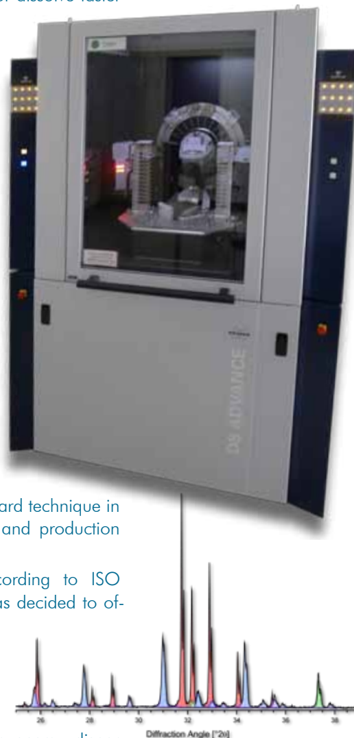
Abbildungen: Bruker D8 Advance der RMS Foundation mit einem Diffraktogramm einer Probe, welche die drei Phasen \beta -TCP (blau), Hydroxylapatit (rot) und CaO (grün) enthält.
