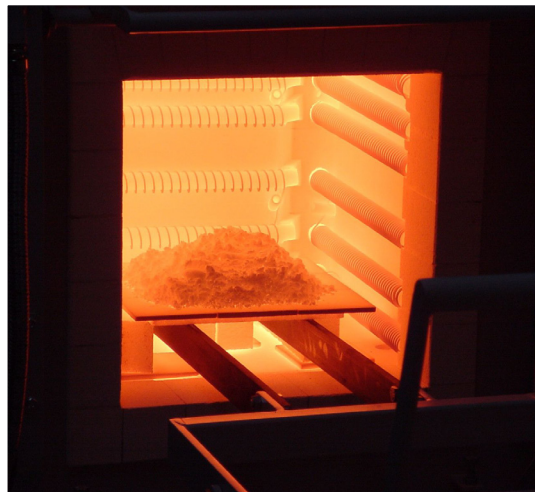
Abbildung 1: Kalziumphosphat-Rohmaterial wird bei 1250 °C dem Ofen entnommen, um schockartig abzukühlen.
