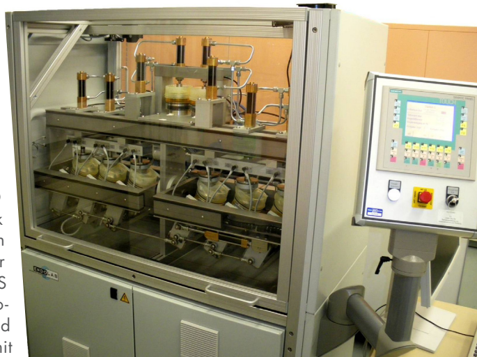
Abbildung 1: Servohydraulischer 6-Stationen Hüft- und Wirbelsäulensimulator.
