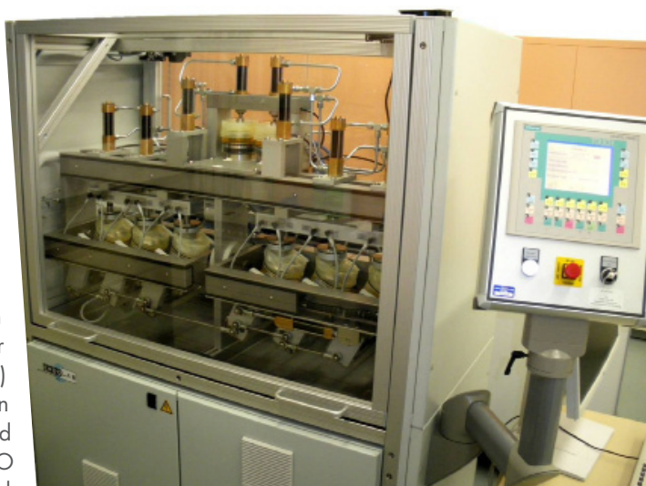
Abbildung 1: Servohydraulischer 6-Stationen Hüft- und Wirbelsäulensimulator.
