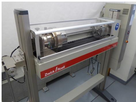
Abbildung 1: Die Torsionsprüfmaschine TL500 von Zwick, mit Erweiterung für gleichzeitige statische Zug- oder Druckbeanspruchung.
