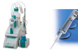
Fig. Titrimo & Autorepipet : tools used for the potentiometric titration
